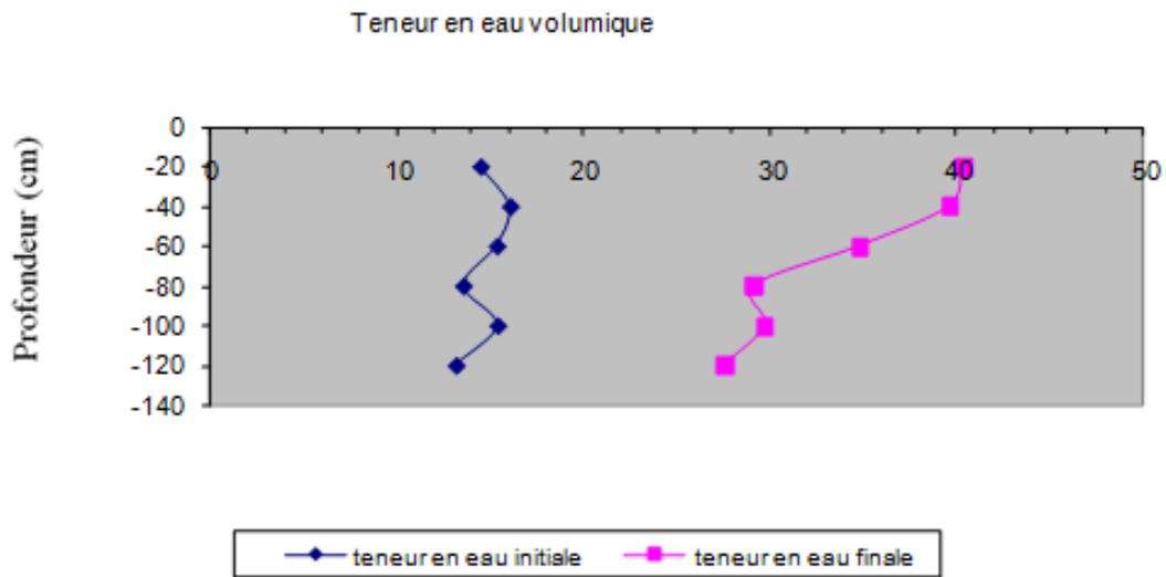
Fig. 9. Profils hydriques sous goutteur au temps initial et à la fin de l'irrigation pour l'irrigation de durée 5 heures.
