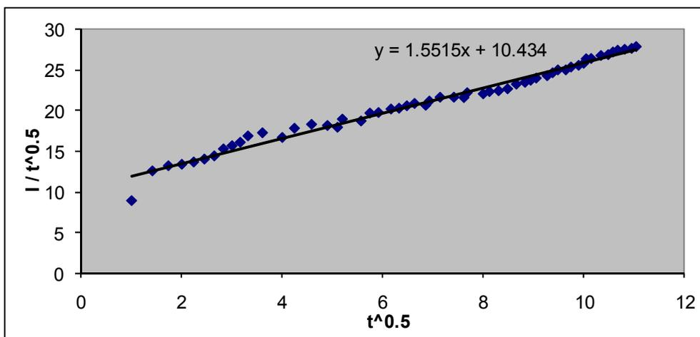
Fig. 3. Détermination de la conductivité hydraulique à la saturation.
