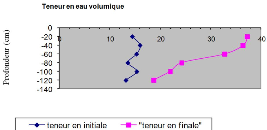
Fig. 8. Profils hydriques sous goutteur pour la durée d'irrigation 3 heures.
