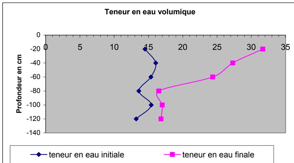
Fig. 7. Profils hydriques sous goutteur avant et à la fin de l'irrigation de durée 2 heures.
