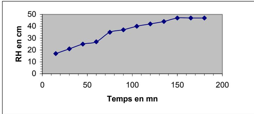
Fig. 6. Evolution du rayon humidifié  $R_H$ , à la surface du sol en fonction du temps (cas de l'irrigation de durée 3 heures).
